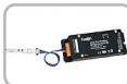
Шаг 4. Подключить соединитель к драйверу при помощи клеммы или специальных разъемов в зависимости от вида соединителя.
