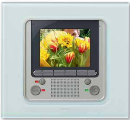
Видеодомофон, внутренний блок Кат. № 675 46 С ЖК-экраном, функцией внутренней связи, автоответчика, автоматического открывания дверей и т. п. Может осуществлять запуск сценариев системы домашней автоматизации My Home
