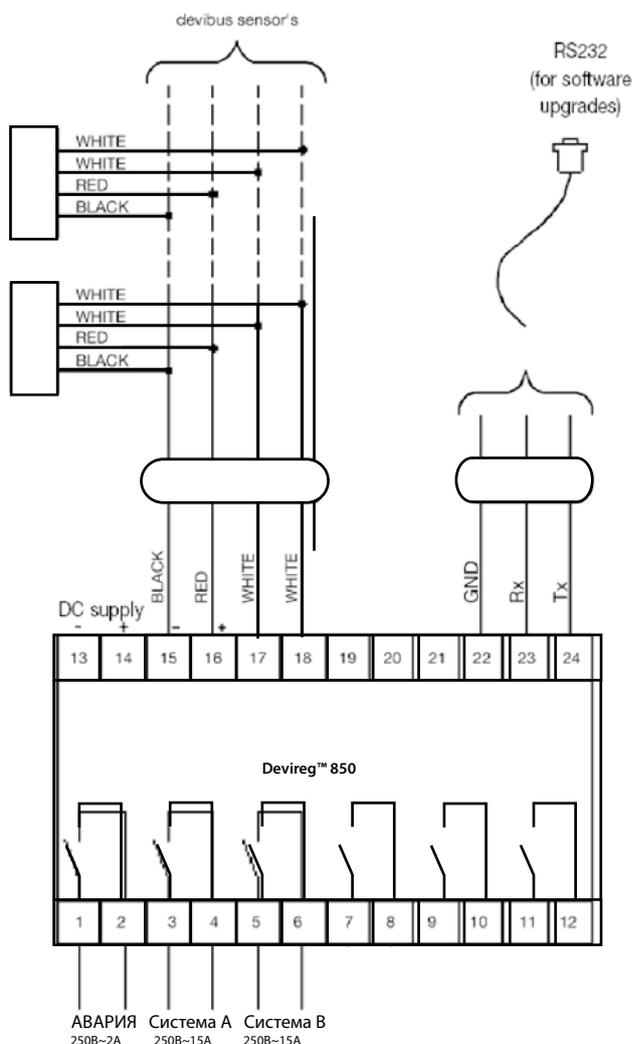
Devireg™ 850 имеет встроенную систему аварийной сигнализации, которая анализирует исправность подсоединенных датчиков и работу микропроцессора самого блока Devireg™ 850. К контактам 1-2 можно также подсоединить внешнюю систему сигнализации.
