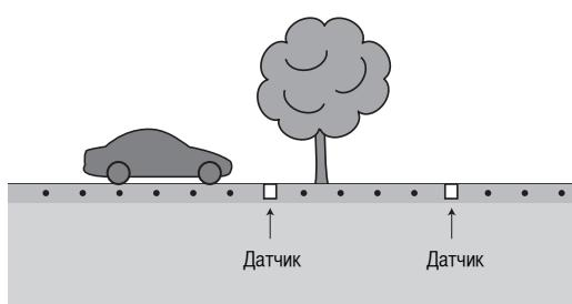
Система с одним датчиком будет менее быстрая, чем система с двумя датчиками, где один измеряет температуру грунта, а другой измеряет влажность.
