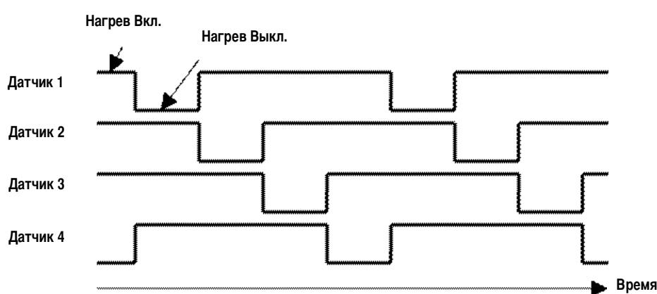
значения регулятору. Если в системе присутствует только два датчика, то всегда попаременно один из них является «подогреваемым», а другой «холодным».
