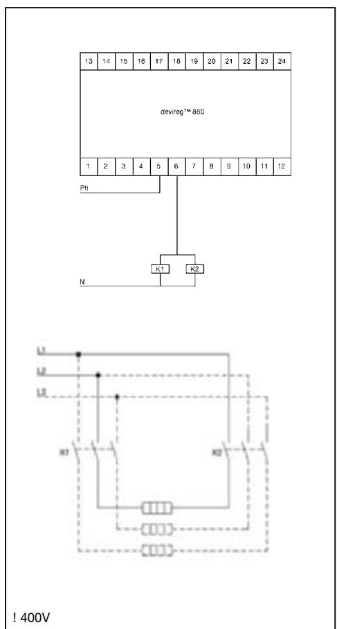
Рис.Ф. Кровля, 2-3 фазы, 1-3 кабеля на 400В
