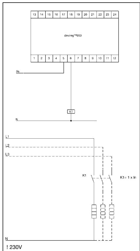
Рис. Д. Кровля, 1-3 фазы, 1-3 кабеля на 230
