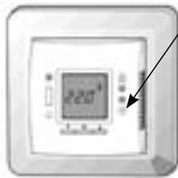
Вы можете войти в этот режим путем нажатия скрытой кнопки
