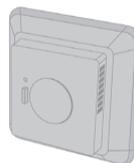
Для контроля системой «Отопления» - поддержания заданной температуры воздуха в помещении, устанавливается терморегулятор Devilink™ RS (Room Sensor). Это устройство имеет встроенный датчик температуры воздуха, дисплей индикации температуры и кнопки снижения/увеличения температуры. Однако включение-выключение нагревательного кабеля осуществляется через Devilink™ FT.
