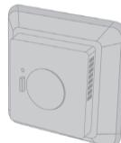
Для контроля системой «Отопления» - поддержания заданной температуры воздуха в помещении, устанавливается терморегулятор Devilink™ RS (Room Sensor). Это устройство имеет встроенный датчик температуры воздуха, дисплей индикации температуры и кнопки снижения/увеличения температуры. Однако включение-выключение нагревательного кабеля осуществляется через Devilink™ FT.
