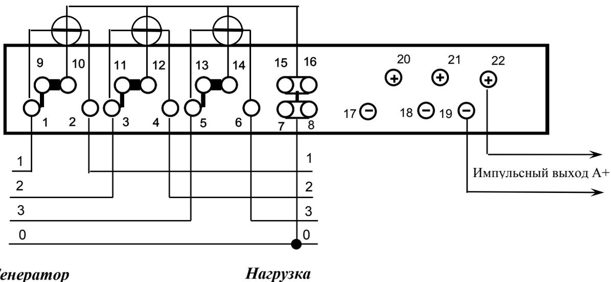
Рисунок В.1 - Схема непосредственного подключения счётчика
