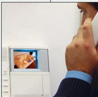
Видеоконтроль посредством видеодомофона за помещением с установленной в нем сигнализацией.
