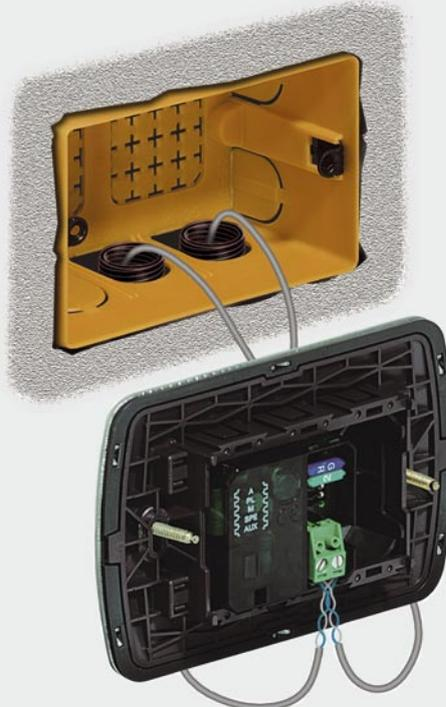
Система с шинной организацией обеспечивает такую же функциональность, как и традиционная кабельная система, при этом использует меньшее количество проводников (только витая пара). Модификация узлов управления и функциональных возможностей не требует изменения кабельной разводки. Достаточно изменить конфигурацию самих устройств.
