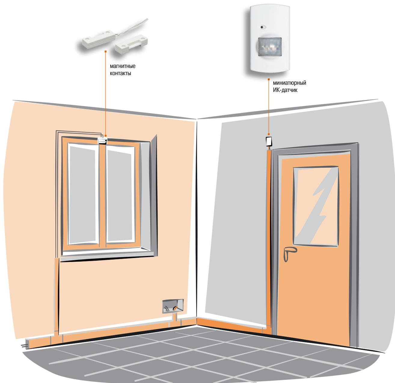
При установке магнитных контактов, рекомендуется заранее предусмотреть канал для проводки кабеля до рамы, где будут расположены сами контакты. После проводки кабеля следует подключить магнитные контакты. Кабель магнитных контактов имеет небольшое сечение, благодаря чему не возникнет проблем при открытии/закрытии окон, ставен и т.п.
