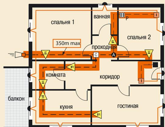
**Примечание:** В длину всех ветвей не включают длину кабелей магнитных NC контактов и соответствующих модулей интерфейсов.
