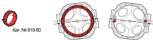
Механизмы крепятся на коробку удлиненными винтами.
