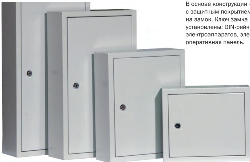
В основе конструкции – сварной металлический корпус с защитным покрытием. Дверца корпуса щита запирается на замок. Ключ замка имеет единый секрет. Внутри корпуса установлены: DIN-рейки для требуемого количества электроаппаратов, элементы для крепления шин N и PE, оперативная панель.
