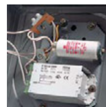
Блок ПРА на полностью емной панели
