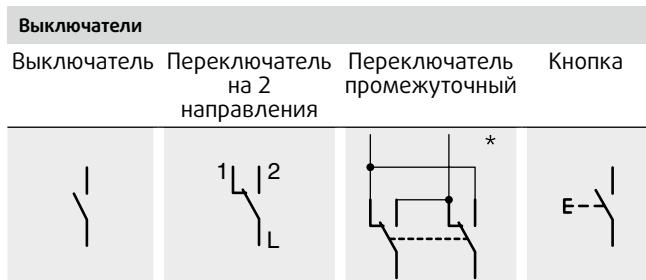
\* Равнозначный символ для функциональной схемы (данний символ не стандартизирован и получен путем сложения двух однополюсных переключателей на 2 направления).
