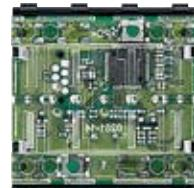
Модуль 1-кнопочного выключателя KNX
