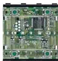
Модуль 2-кнопочного выключателя KNX
