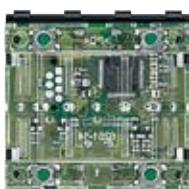
Модуль 2-кнопочного выключателя KNX
