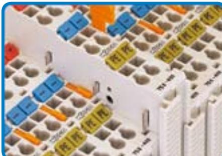
Надежное автоматическое соединение благодаря луженым самоочищающимся скользящим контактам высокой надежности соединения – контакт заземления подсоединяют первым и отсоединяют последним.
