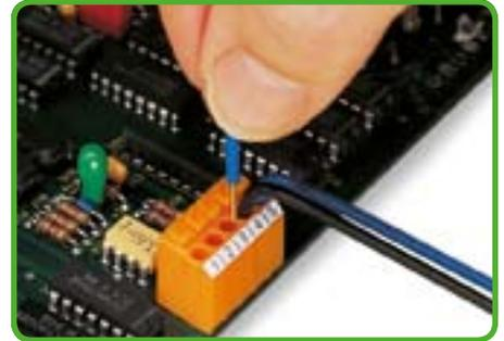
Клемма для одножильного проводника сечением 0,5 мм<sup>2</sup> – 1,5 мм<sup>2</sup>/AWG 20 – 16
