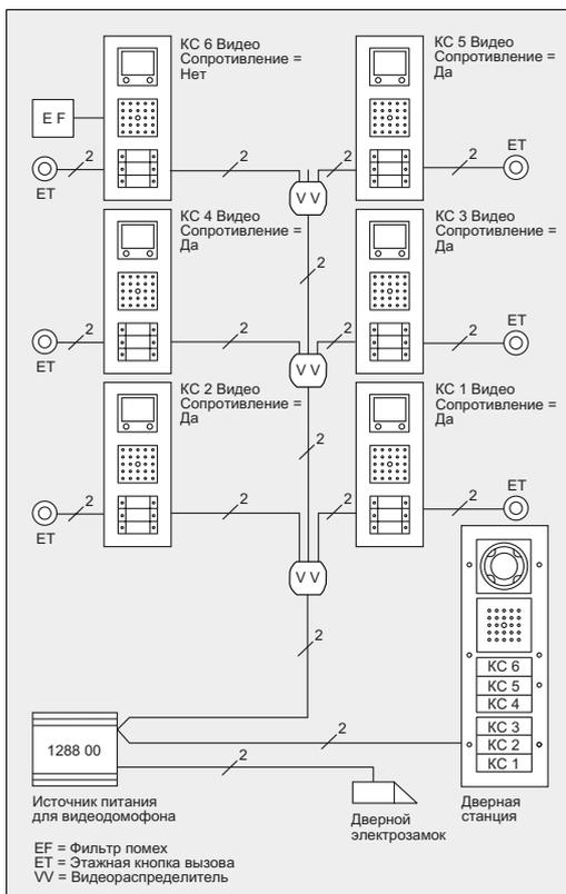
При реализации лучевой топологии соединения домофонных устройств с шиной рекомендуется использовать разветвляющие монтажные коробки.
