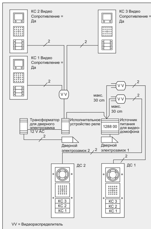
Две (не более) дверных станции с цветными видеокамерами и видеораспределитель подключаются к источнику питания. Длина линии на выходе видеораспределителя не должна превышать 30 см.
