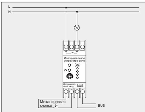
Светильник включается нажатием клавиши «Свет» [«Licht»] на квартирной станции. Такую же функцию могут выполнять и простые механические кнопки (замыкатели), подключенные на дополнительный вход.
