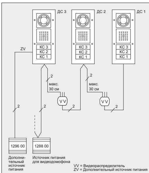
При использовании сразу нескольких дверных станций с цветными видеокамерами их необходимо соединять между собой при помощи видеораспределителя. Длины линии на выходе видеораспределителя не должны превышать 30 см.
