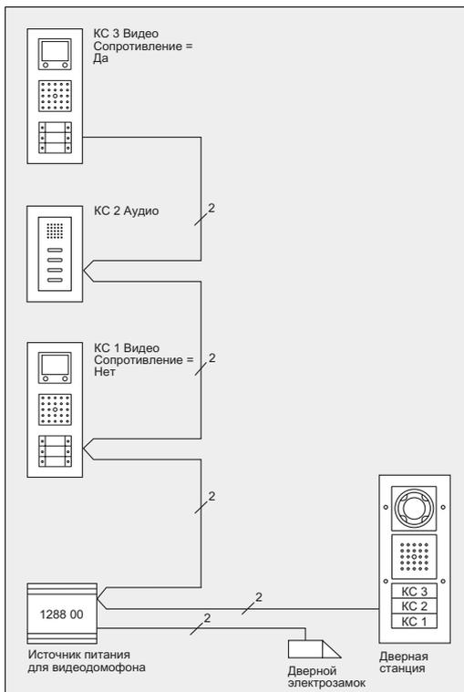
Квартирные станции без видеокомпонентов могут легко подключаться к двухпроводной шине, совершенно не влияя на состояние согласующего сопротивления на последней квартирной станции.
