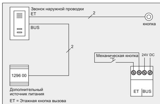
В комбинации с механической кнопкой вызова и дополнительным источником питания звонок накладного монтажа может выполнять функцию обычного дверного звонка.
