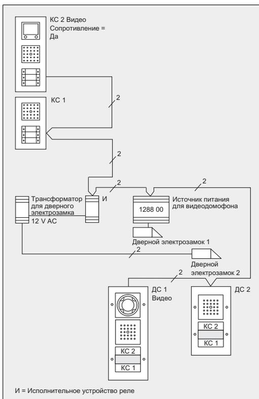
Дверная станция с цветной видеокамерой должна располагаться на тупиковой ветке шины. В этом случае подключение аудиодомофона осуществляется очень просто.
