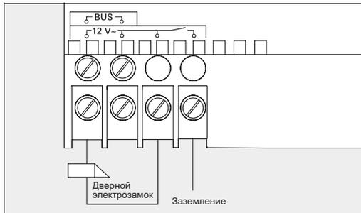
Для управления и запитывания дверного электрозамка (подключаемого к переменному напряжению 8 - 12 В, максимальному току 1,1 А), необходим источник питания с выходом на 12 В переменного напряжения. Примечание: источник питания имеет настройку времени выдержки (от 1 до 10 секунд), т.е. времени в течение которого на дверной электрозамок будет подаваться напряжение питания.
