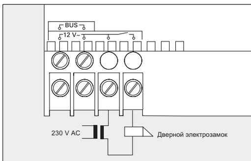
Источник питания аудиодомофона имеет дополнительный выход, используемый в том случае, когда используемый дверной электрозамок не удовлетворяет требованиям выхода на 12 В переменного тока.
