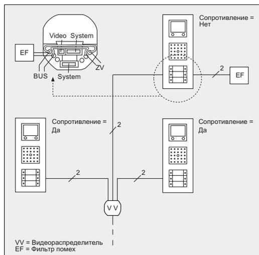
Фильтр помех устанавливается на самой последней/удаленной квартирной станции. Подключение осуществляется через 2-проводную линию на клеммы BUS шинного контроллера.
