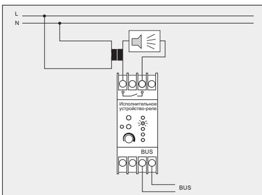
Дополнительное устройство сигнализации (внешний звонок и т.п.) включается нажатием дополнительной кнопки вызова квартирной станции.
