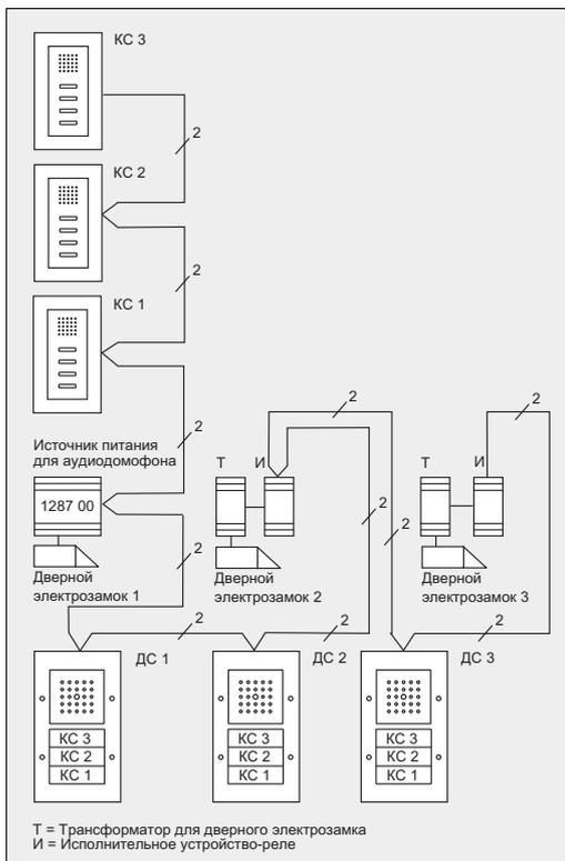
На примере показано, как в больших аудиодомофонных системах реализуется шлейфовое соединение. Соединение отдельных компонентов производится в монтажной коробке для скрытого монтажа шинного контроллера, что освобождает от необходимости применения других дополнительных разветвительных коробок.
