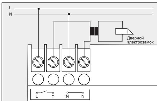
Дверной электрозамок, который по своим электрическим параметрам (например, из-за низкоомного входа или номинального питания на 24 В переменного напряжения) не может подсоединяться напрямую на клеммы «12 V~», подключается к внешнему источнику питания (230 В ~, до 2 А) через беспотенциальный контакт блока питания.
