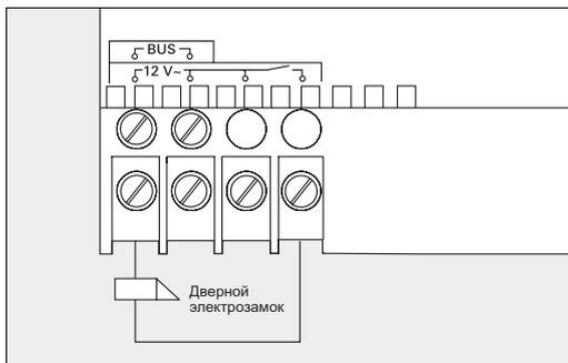
Дверной электрозамок (переменное напряжение 8-12 В, максимальный ток 1,6 А) может напрямую подключаться к выходу реле.
