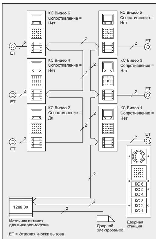
При шлейфовой топологии провода шины последовательно протягиваются от устройства к устройству.
