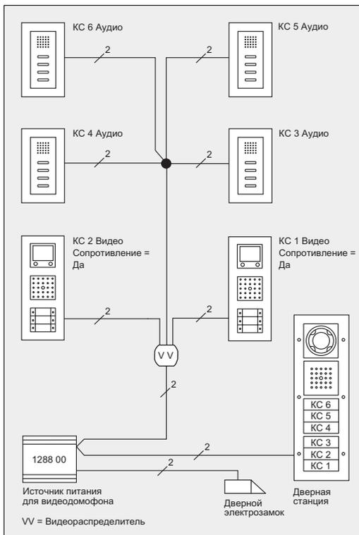
Квартирные станции без видеокomпонентов могут подключаться к узлу развязки без использования видеораспределителя.
