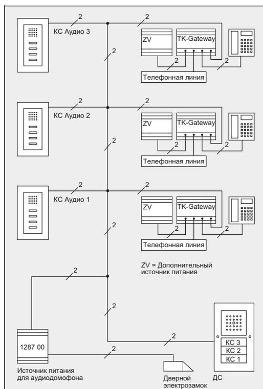
В многоквартирном доме установлен домофон с тремя клавишами вызова. В каждой квартире находится квартирная станция, а, кроме того, через TK-Gateway установлено подключение к телефонной линии.
