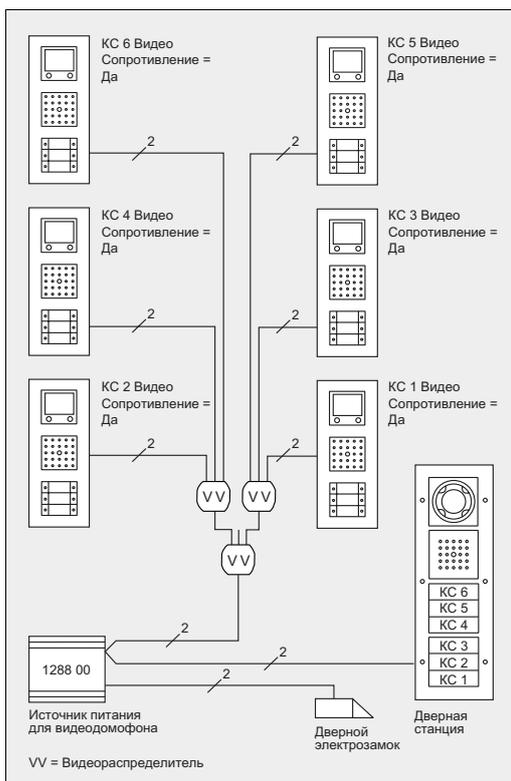
Несмотря на то что в данном примере используются три видеораспределителя, необходимости применения фильтра помех не возникает. Каскадирование видеораспределителей позволяет передавать видеосигнал от домофона до самой удаленной квартирной станции с помощью всего лишь двух видеораспределителей (фильтр помех используется, если видеосигнал проходит через три или более видеораспределителя).
