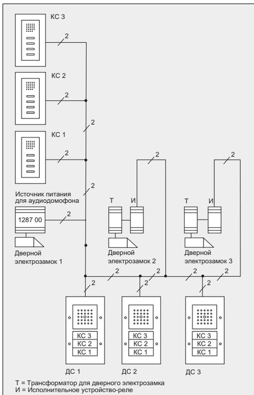
В домофонных системах, состоящих только из аудиоустройств, видеораспределитель не требуется; все компоненты такой системы просто соединяются между собой при помощи двухпроводного соединения. Разводка узлов осуществляется при помощи монтажных коробок скрытого монтажа.
