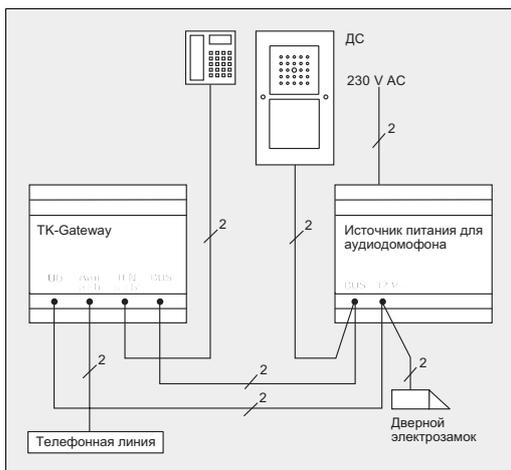
При использовании интерфейса TK-Gateway с аналоговым подключением телефонный кабель коммутируется на разъем «TLN». Соответственно, все приходящие от домофонных систем вызовы направляются на него.
