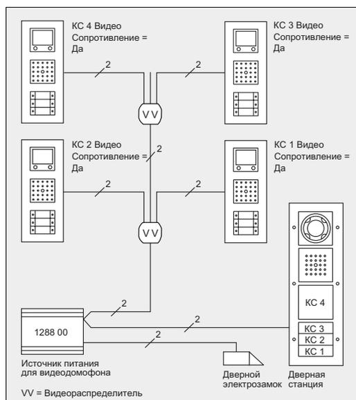
Сопротивления на тупиковых линиях квартирных станций подключены.
