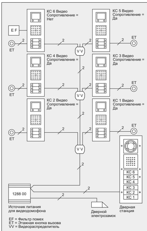
Если видеосигнал проходит через три и более видеораспределителя, то на самой удаленной квартирной станции с цветным TFT-дисплеем необходимо установить фильтр помех. На этой же квартирной станции при первом включении цветного TFT-дисплея согласующее сопротивление должно быть отключено, т.е. установлено в положение «Нет».
