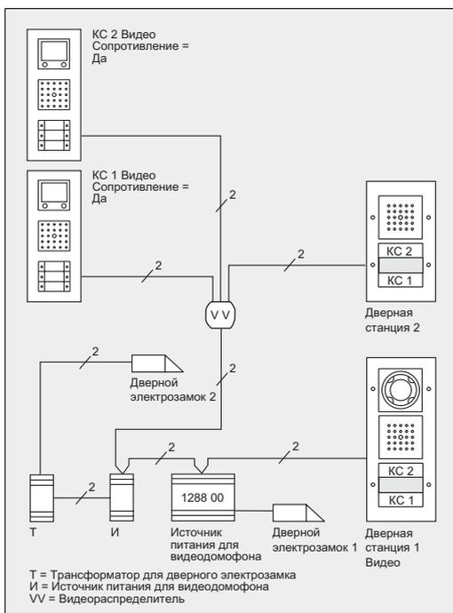
В данном примере для устранения отражений видеосигнала дверная аудиодомофонная станция подключена через видеораспределитель.
