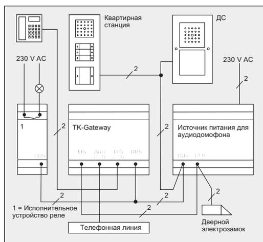
В частном доме установлен домофон и квартирная станция с дополнительной клавишей вызова. Помимо этого к квартирной станции параллельно подключен интерфейс TK-Gateway, питание которого осуществляется через источник питания аудиодомофона.
