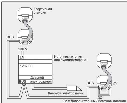
Двухпроводная шина подключается к шинному контроллеру дверной станции и квартирной станции. Вставки домофонных компонентов скрытого монтажа соединяются между собой при помощи 6-жильного аудиокабеля.
