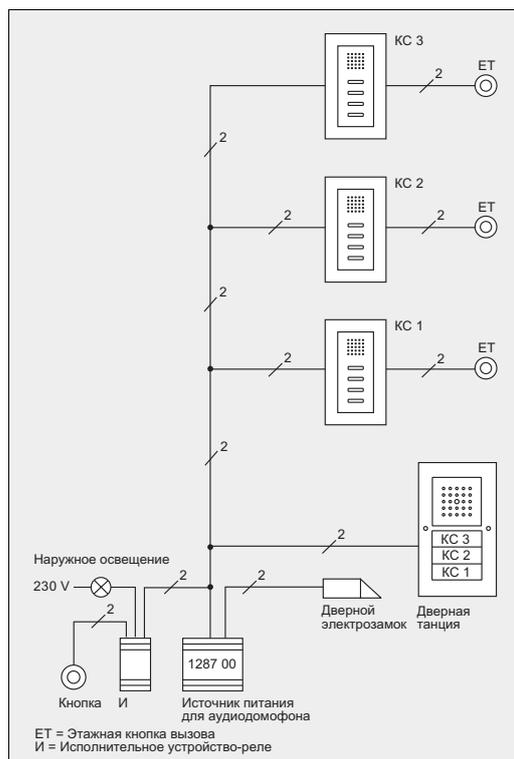
Трехквартирный дом оснащен тремя аудиодомофонными станциями. Замок входной двери отпирается нажатием клавиши на любой из трех квартирных станций.
