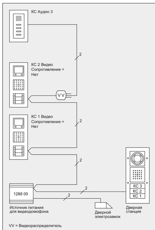
Если на тупиковом конце линии установлена квартирная станция без видеофункции, ее следует подключать через видеораспределитель, чтобы устранить отражение видеосигнала.
