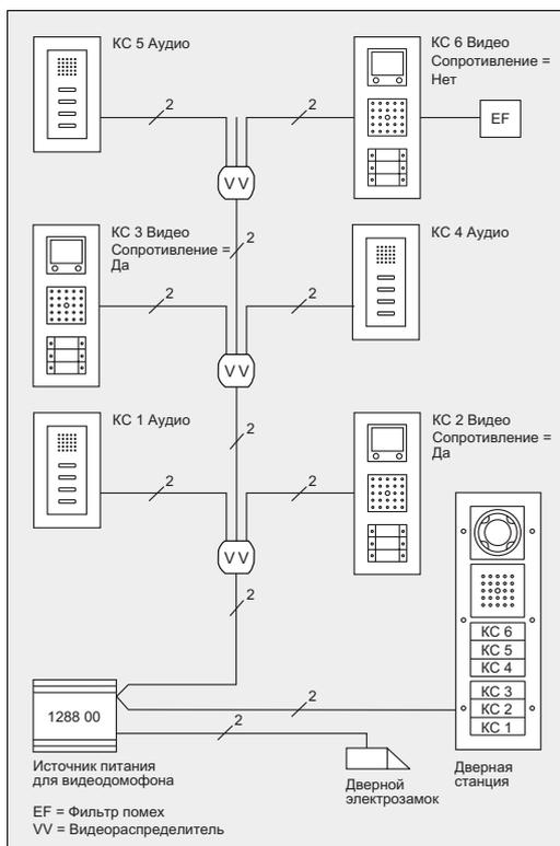
Если спроектированная топология системы такова, что видеосигнал проходит через три и более видеораспределителя, то к самой удаленной квартирной станции с цветным TFT-дисплеем необходимо подключить фильтр помех. Фильтр помех подключается параллельно квартирной станции, находящейся на самом удаленном участке.
