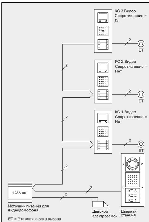
Согласующее сопротивление на последней квартирной станции с цветным TFT-дисплеем подключено.
