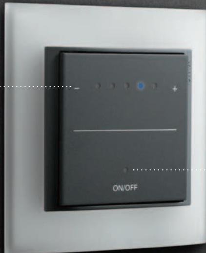
В нижней половине поверхности накладки находится светодиод, светящийся тогда, когда нагрузка выключена. Касанием нижней части накладки подается команда на включение до уровня яркости, записанного в ее памяти. Чтобы выключить сенсорный светорегулятор Gira, достаточно легкого прикосновения к нижней половине поверхности накладки.
