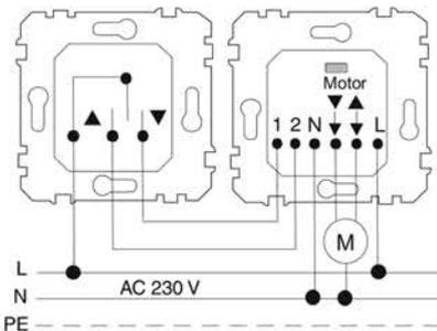
При коротком нажатии на кнопочный выключатель для рольставней с самовозвратом механизм управления жалюзи не блокируется (длительный режим). Вы можете переместить жалюзи в нужную позицию, удерживая кнопочный выключатель с самовозвратом нажатым. Рекомендуется использовать: Для электромонтажа двух механизмов использовать между ними провод 5 x 1,5мм<sup>2</sup> (1, 2, L, N, PE).
