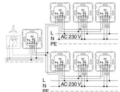
При подаче аварийного сигнала при ветре жалюзи поднимаются и остаются заблокированными в верхней позиции, пока ветер не утихнет. Поэтому жалюзи в таком случае нельзя управлять вручную или автоматически.
