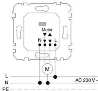
**Дополнительное место управления механизмом кнопочного выключателя для рольставней (315500) в качестве дополнительного модуля**
