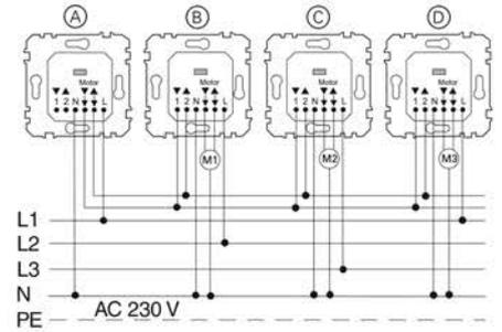
Механизмы в централизованном управлении распределяются по нескольким фазам. Механизмы можно подключать к различным фазам произвольно.
