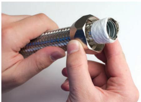
1. Вначале следует надеть на металлорукав зажимную гайку
