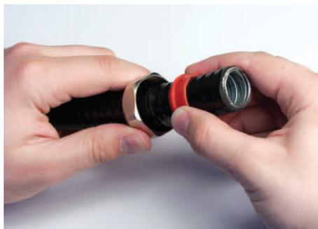
1. Вначале следует надеть на металлорукав зажимную гайку, затем зажимное уплотнительное кольцо красного цвета. Уплотнительное кольцо надевается стороной с утолщением под зажимную гайку
