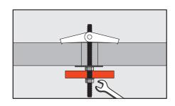
**3. Окончательно зафиксировать** При затягивании гайки происходит окончательная фиксация анкера
