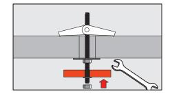
**2. Закрепить монтируемую деталь** В пустоте стопорные крылья под воздействием пружины открываются
