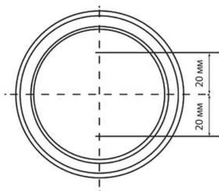
4.1. Определить и отметить центр местоположения выключателя (розетки) на стене. Разметить места под крепежные саморезы на расстоянии 20 мм от центра местоположения выключателя (розетки).
