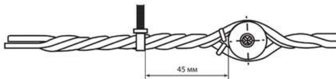
4.4. На расстоянии 45 мм от изолятора на подводимом проводе закрепить провод хомутом.
