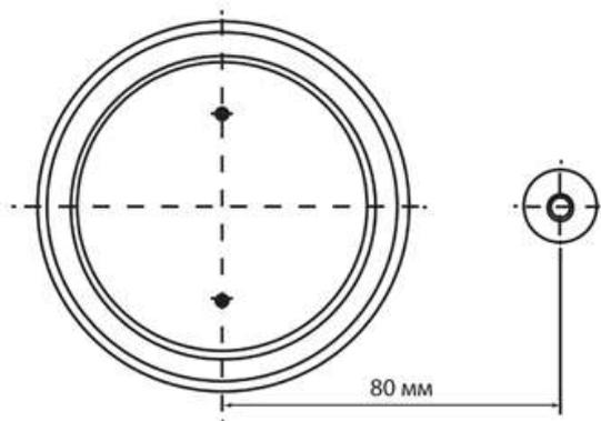
4.2. Определить и отметить место расположения изолятора, на котором будет крепиться подводный провод (80 мм). Закрепить изолятор.
