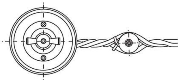
4.8. Установить основание выключателя (розетки) таким образом, чтобы хомутная стяжка, закрепленная на проводе, оказалась внутри него.
