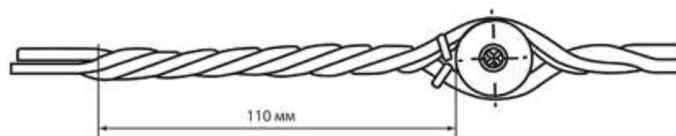
4.3. Закрепить провод на изоляторе (свободный конец провода должен составлять не менее 110 мм).
