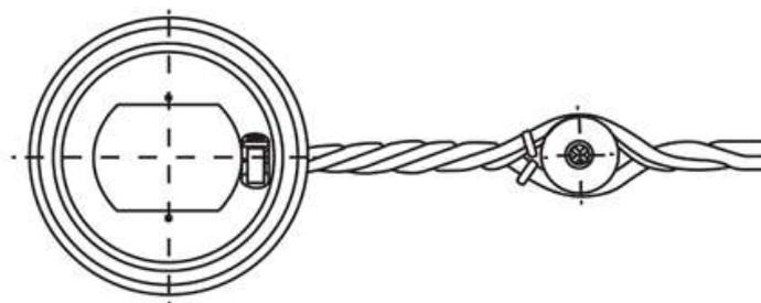
4.10. Установить корпус выключателя (розетки) и закрепить его при помощи крепежных саморезов.
