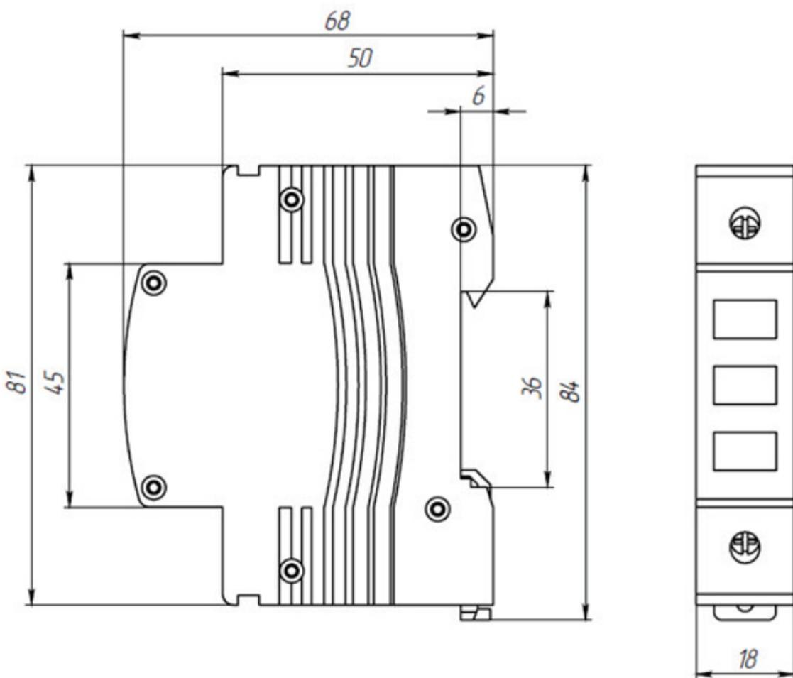
Рисунок 1 – Габаритные размеры
