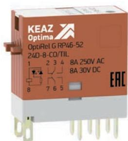
Миниатюрное промышленное реле серии RP46 представляет собой подключаемое миниатюрное реле с двумя силовыми перекидными контактами, контрольной кнопкой, механическим индикатором состояния и светодиодом. Материал контактов — AgSnO2. Реле серии RP46 совместимы с розеткой для реле серии RR97.
