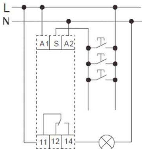
A1, A2 – клеммы подключения питания;
