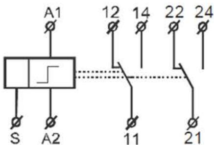
A1, A2 – клеммы подключения питания;
