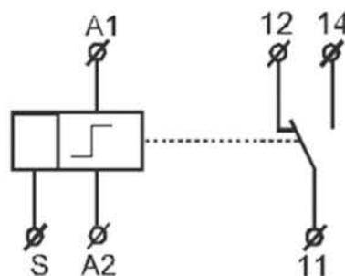
A1, A2 – клеммы подключения питания;
