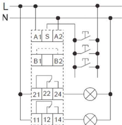
A1, A2 – клеммы подключения питания;
