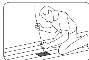
Для прохождения сложной геометрии кабельных каналов протяжка должна обладать определенной гибкостью. Одновременно протяжке необходима жесткость и способность держать форму для преодоления поворотов и сил трения, вызванных контактом с трубами и расположеннымими в них кабелями. Поэтому при выборе материала протяжки следует учитывать комбинацию свойств и их оптимальный баланс. Идеальной протяжки не существует. У каждого материала есть свои преимущества и недостатки.
