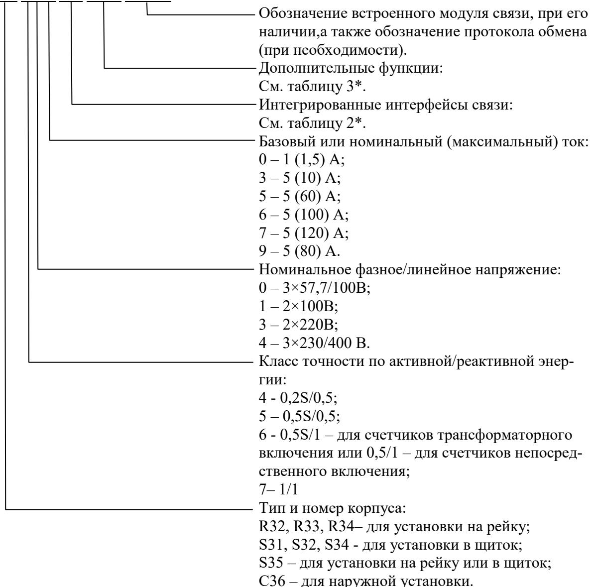
Рисунок 1 - Структура условного обозначения счетчиков
