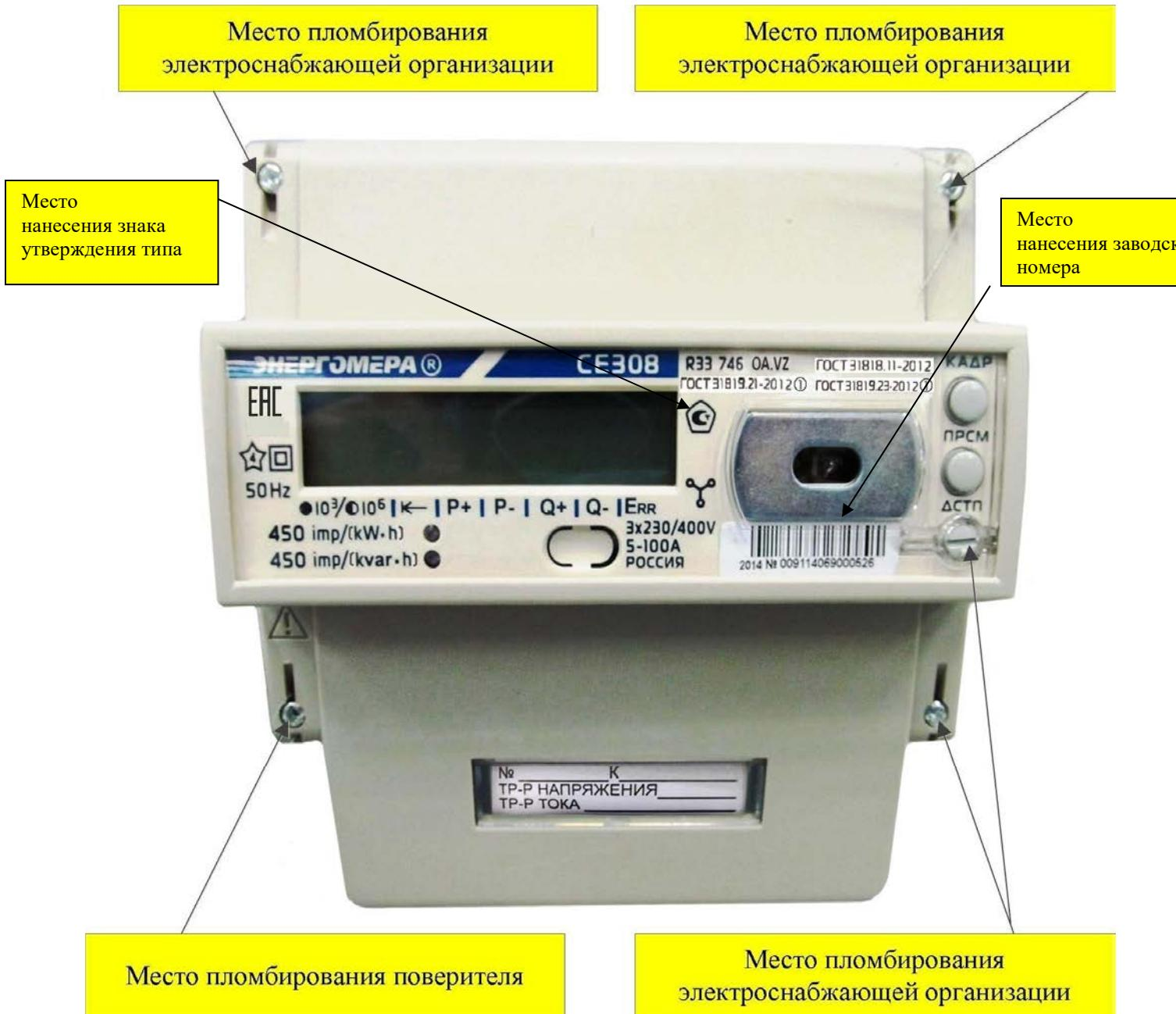
Рисунок 3 – Общий вид счетчика CE308 R33\*
