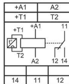
В изделиях с исполнением ACDC10-30В напряжение питания подаётся на клеммы «+A1», «A2». При питании реле постоянным напряжением «+Uпит» подключать на клемму «+A1».
