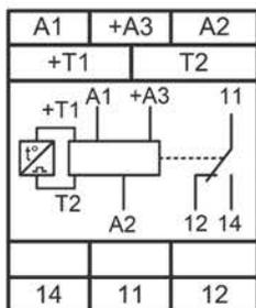
В изделиях с исполнением AC230В напряжение питания ACDC24В подаётся на клеммы «+A3», «A2». При питании реле постоянным напряжением «+Uпит» подключать на клемму «+A3». Напряжение питания AC230В подаётся на клеммы «A1», «A2». На A1 подается L - фаза, на A2 подается N - нейтраль.
