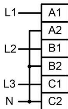
Измерение фазного напряжения
