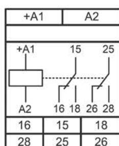
В изделиях с исполнением ACDC10-30B, ACDC36B, DC6В напряжение питания подаётся на клеммы «+A1», «A2». При питании реле постоянным напряжением «+Упит» подключать на клемму «+A1».
