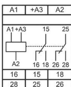
В изделиях с исполнением ACDC24B/AC230В напряжение питания ACDC24B подаётся на клеммы «+A3», «A2». При питании реле постоянным напряжением «+Упит» подключать на клемму «+A3». Напряжение питания AC230В подаётся на клеммы «A1», «A2».
