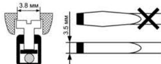
Следует использовать отвертку 0,6\*3,5мм
