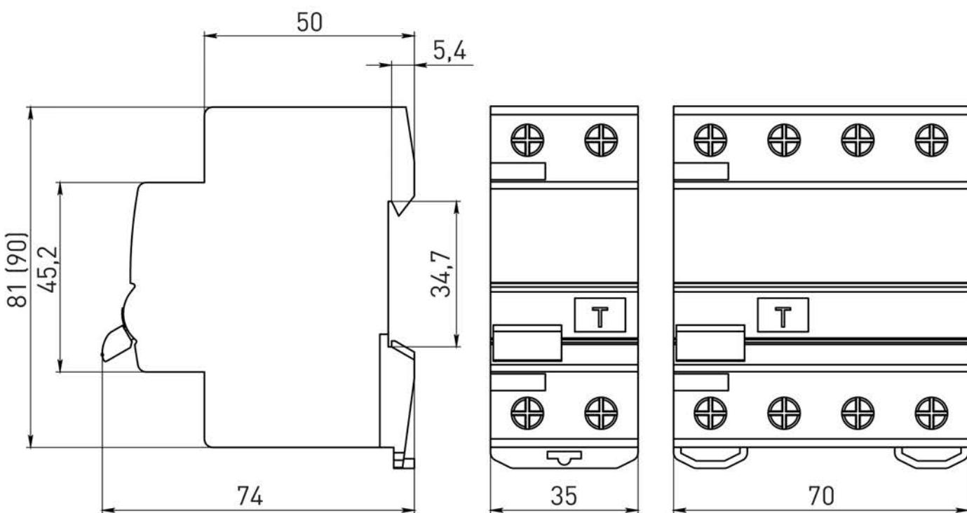
Рис. 1 - Габаритные размеры
