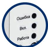
Выходное реле для системы диспетчеризации и три светодиода для индикации режимов работы и состояния.
