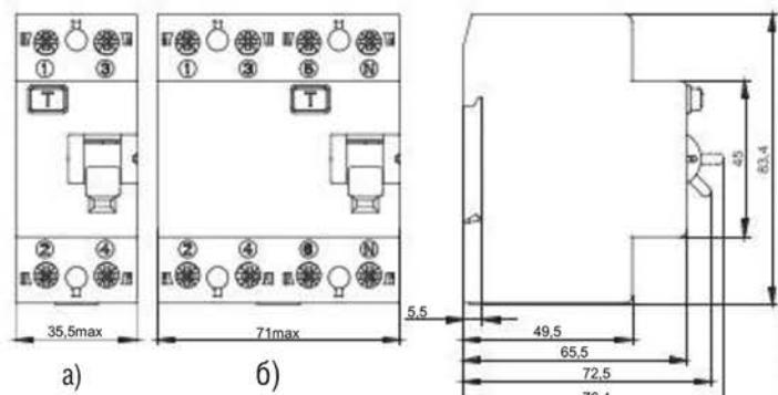
Рисунок Б.1 - Габаритные, установочные и присоединительные размеры ВДТ на номинальные токи 25-63А
