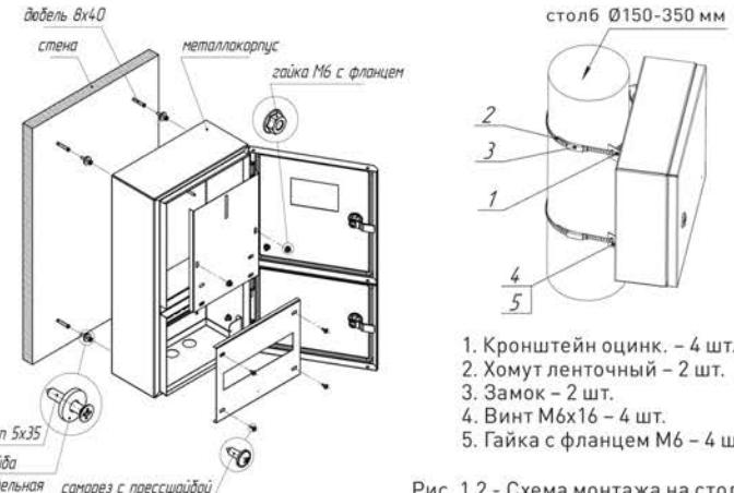
Рис. 1.1 - Схема настенного монтажа
