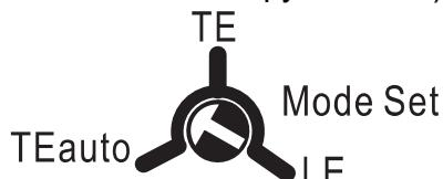
Выключите лампу. С помощью небольшой отвёртки выберите необходимый режим.
