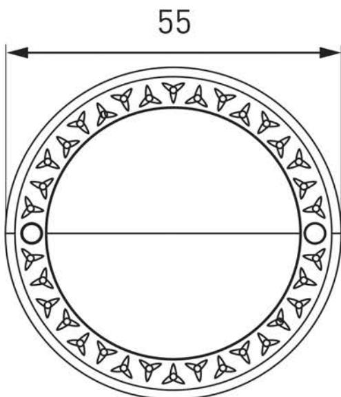
Рис. 3 – Габаритные размеры датчика
