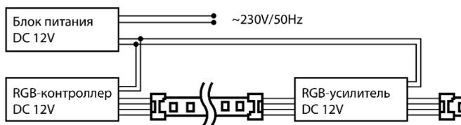
Рис. 1 Схема последовательного подключения с одним источником питания
