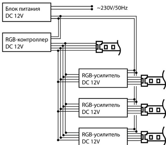
Рис. 1 Схема параллельного подключения с одним источником питания
