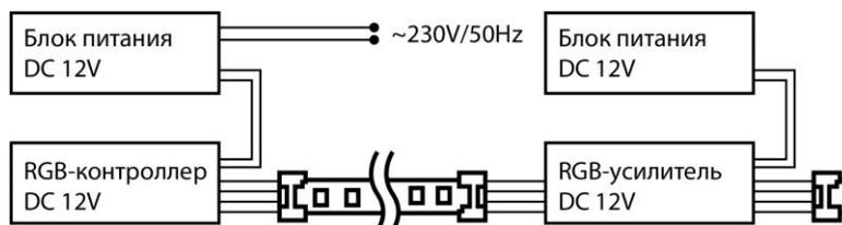
Рис. 1 Схема последовательного подключения с несколькими источниками питания
