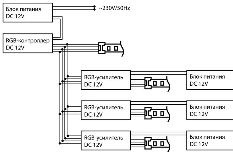
Рис. 2 Схема параллельного подключения с несколькими источниками питания
