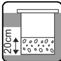
5.4 Проверьте работоспособность дренажной системы. Для этого заполните монтажную лунку водой и проверьте удалилась ли вода за 30 минут. Если этого не произошло, то увеличьте высоту дренажной системы, либо рассмотрите возможность монтажа водоотводящего трубопровода.
