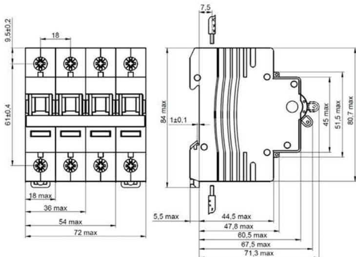
Рисунок Б.1 - Габаритные, установочные, присоединительные размеры выключателей.
