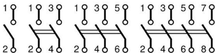
а) однополюсного; б) двухполюсного; в) трехполюсного; г) четырехполюсного.
