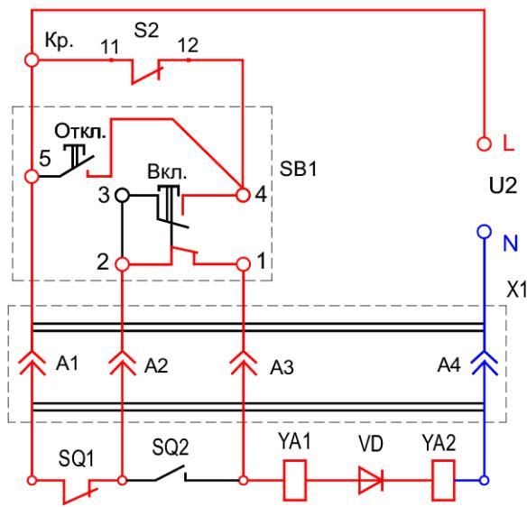
Электрическая схема отключения привода электромагнитного
