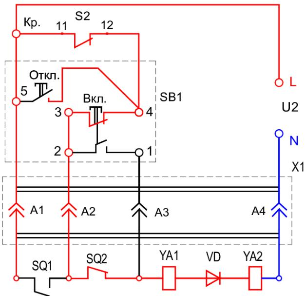
Электрическая принципиальная схема привода
