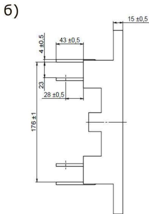
**Рисунок Б.9** - Панель втыччная ВА57-35
