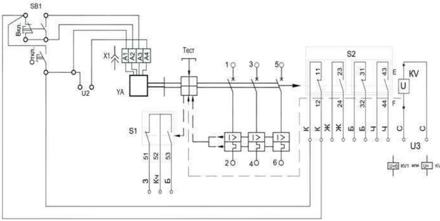
**Рисунок Г.4** - Схема электрическая принципиальная выключателей стационарного исполнения, с нулевым или минимальным расцепителем напряжения, вспомогательными контактами сигнализации автоматического отключения, вспомогательными контактами и электромагнитным приводом
