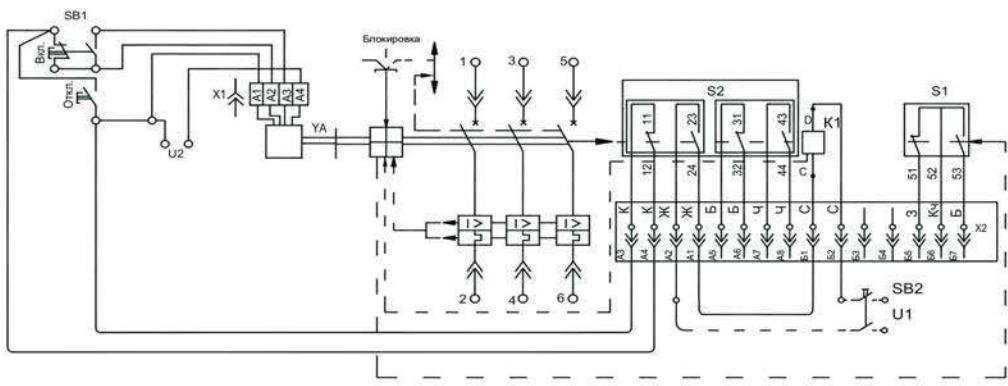
**Рисунок Г.5** - Схема электрическая принципиальная выключателей выдвижного исполнения, с независимым расцепителем, вспомогательными контактами, вспомогательными контактами сигнализации автоматического отключения и электромагнитным приводом
