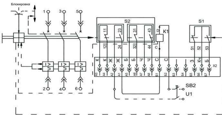
**Рисунок Г.6** - Схема электрическая принципиальная выключателей выдвижного исполнения, с независимым расцепителем, вспомогательными контактами, вспомогательными контактами сигнализации автоматического отключения
