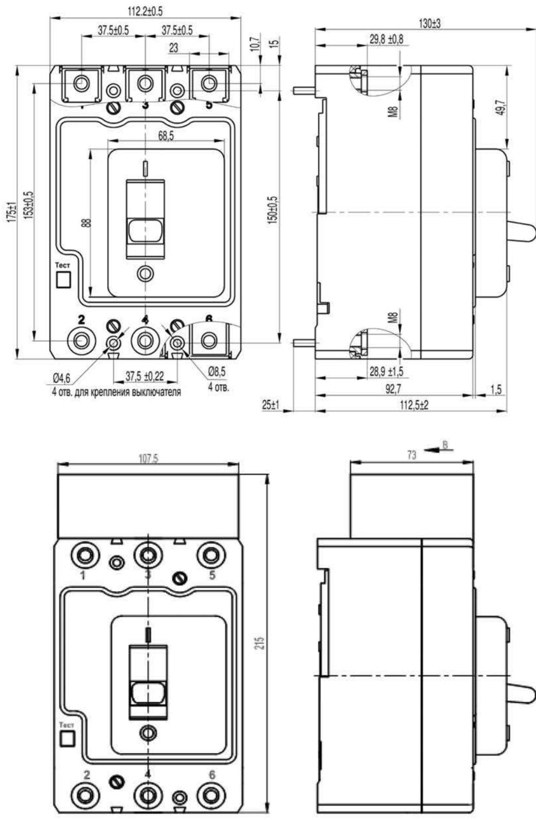
**Рисунок Б.1 – Выключатель ВА57-35 с зажимами для переднего присоединения**
