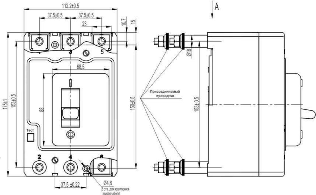
**Рисунок Б.2** - Выключатели с зажимами для заднего присоединения (только BA57-35 стационарного исполнения без регулировки максимальных расцепителей тока)
