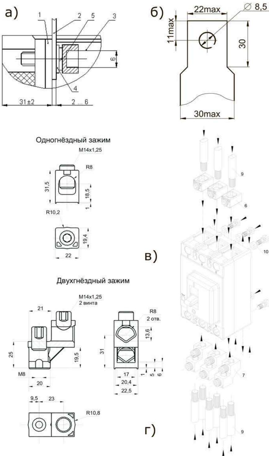
1 – вывод выключателя, 2 – шина (или кабельный наконечник), 3 – выключатель, 4 – шайбы, 5 – винт M8, 6 – одногнездный зажим, 7 – двухгнездный зажим, 8 – винт M8, 9 – присоединяемый проводник, 10 – втулка (используется со стороны выводов 1, 3, 5).
