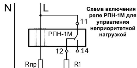
Схема включения реле РПН-1М для управления неприоритетной нагрузкой
