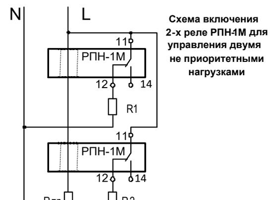
Схема включения 2-х реле РПН-1М для управления двумя не приоритетными нагрузками
