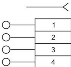
Рисунок 1 – Схема электрическая принципиальная телефонных розеток серии GLORY
