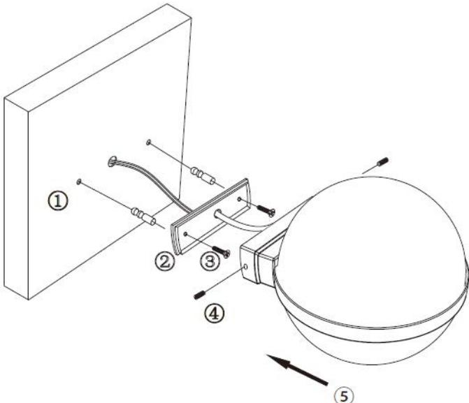
1. Снимите основание светильника, выкрутив сбоку два удерживающих винта. Для этого используйте шестигранный ключ на 2.
