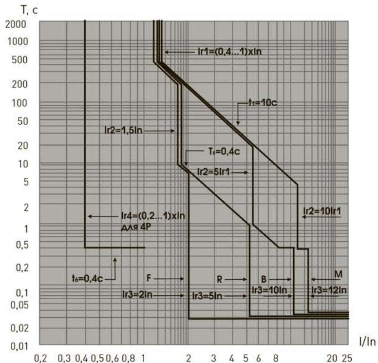
Характеристика расцепления выключателя при отключении по  $I^2 t$
