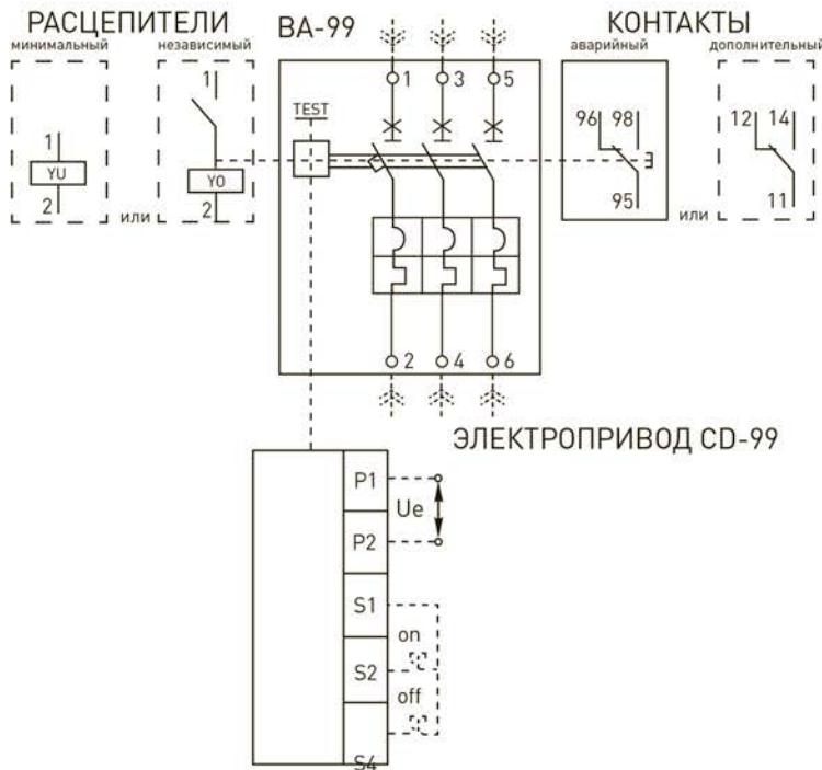
Автоматический выключатель с микропроцессорным расцепителем и дополнительными устройствами
