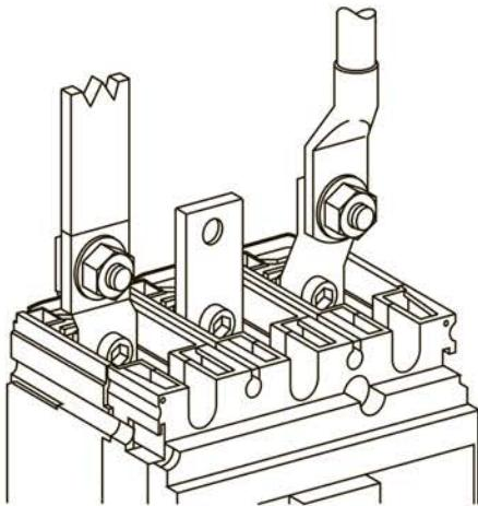
Подвод напряжения от источника питания допускается как сверху, так и снизу выключателя.
