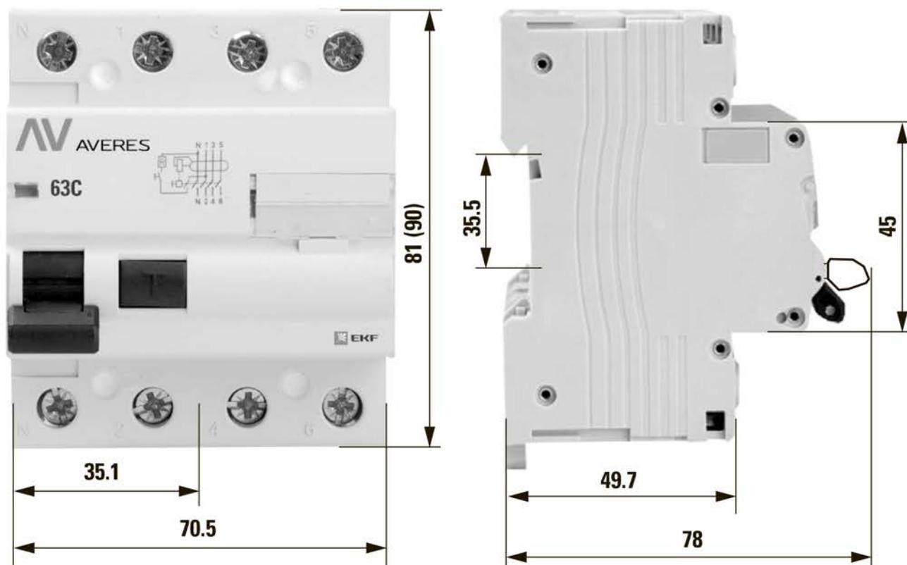
Рис. 1 - Габаритные размеры
