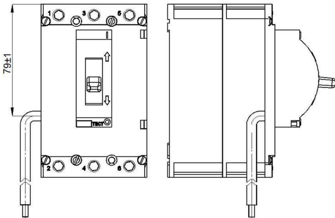
**Рисунок Б.2** - Расположение выходящих из выключателя проводов от дополнительных сборочных единиц
