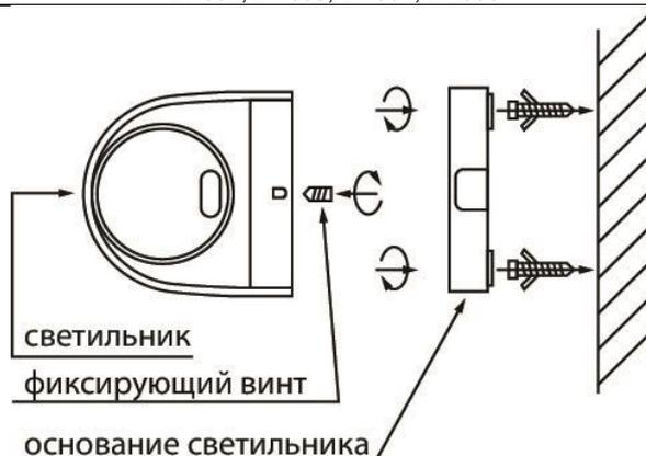
1. Снимите основание светильника, выкрутив сбоку два фиксирующих винта.
