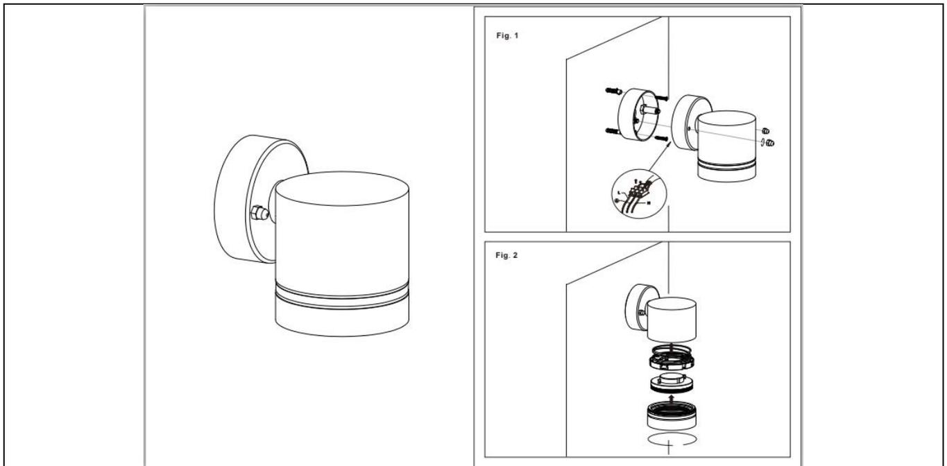
1. Снимите основание светильника, выкрутив сверху две удерживающие декоративные гайки.
