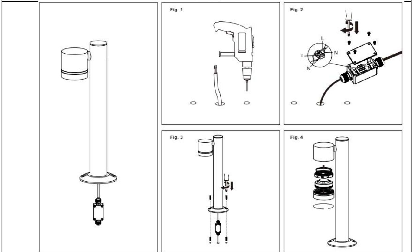
1. Используя основание светильника, просверлите в монтажной поверхности два отверстия и вставьте в отверстия пластиковые дюбели.
