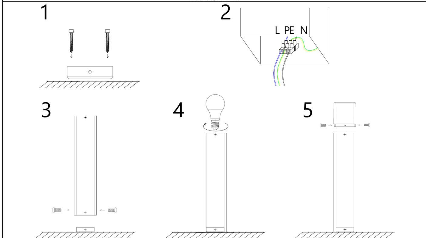
1. Осуществите подвод кабеля питания к месту установки светильника. Фаза питающего кабеля должна подаваться через защитный автоматический выключатель на 10А. Кабель должен содержать три провода: фазу, нейтраль и провод защитного заземления. Кабель должен быть защищен от механических повреждений. Для этого глубина кабельного канала должна составлять не менее 60см. Для защиты кабеля используйте гофру.
